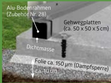
Eine gute und preiswerte Lösung sind im Splittbett verlegte Gehwegplatten. Wir empfehlen unbedingt die Verwendung des **Alu-Bodenrahmens**.
